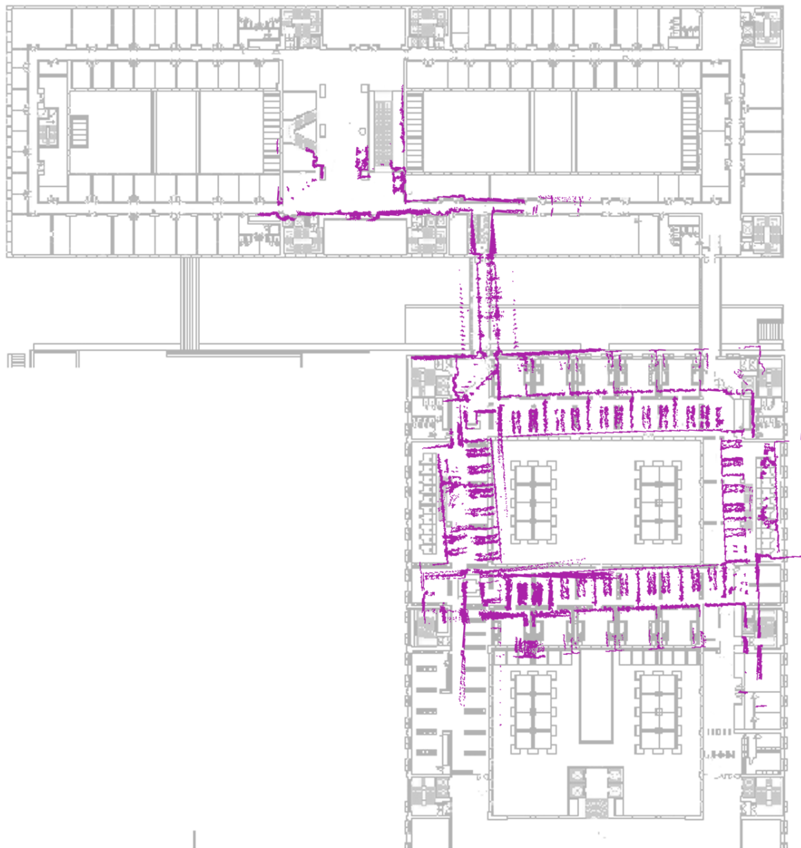
Figura 5.27: Mapa generado por odometría para el recorrido 26b
