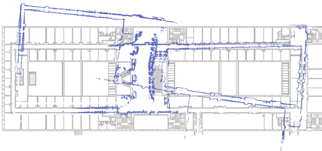
Figura 5.24: Mapa generado por localización por EKF utilizando covarianzas fijas para ICP para el recorrido 27b
