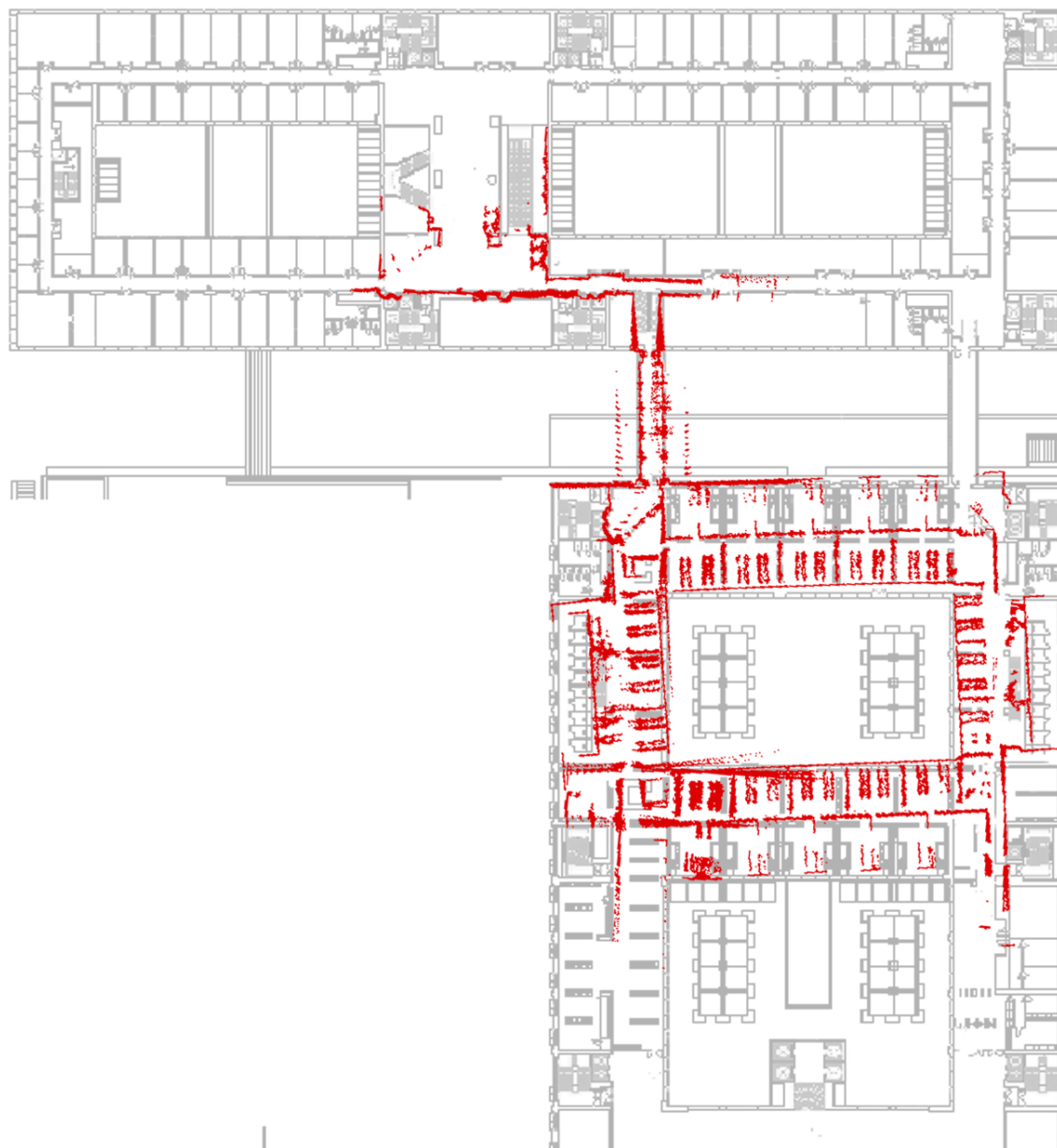
Figura 5.30: Mapa generado por localización por EKF utilizando covarianzas calculadas para ICP para el recorrido 26b
