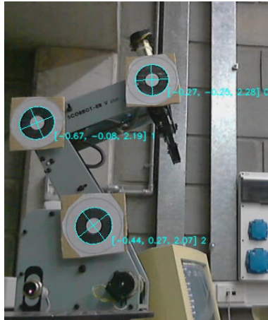
Figura 1.7: Sistema de localización externa calculando la posición 3D de las tres circunferencias de la imagen.
