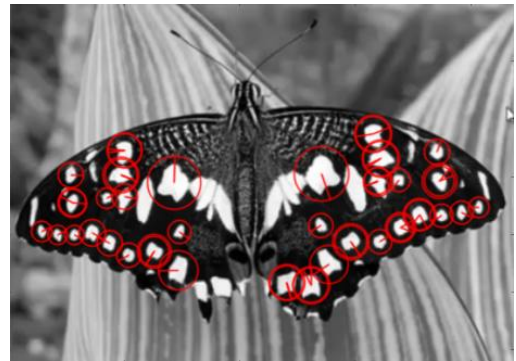
Fig. 2.0.7: Regiones de interés detectadas por el método SURF.
