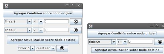
**Figura 44:** Ejemplo de configuración de condiciones para las transiciones del comportamiento complejo buscar y seguir la línea en el piso con el robot ExaBot de la Figura 43. A la izquierda, las condiciones y actualizaciones de la transición con nodo origen-*buscar* y destino-*encarrilar*. A la derecha, las condiciones de la transición con nodo origen-*encarrilar* y destino-*seguir*.
