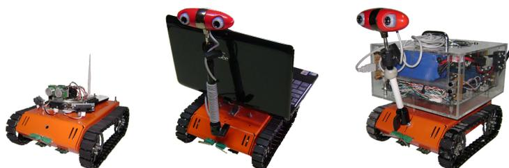
**Figura 8:** Robot ExaBot, tres de sus configuraciones más utilizadas. De izquierda a derecha, configuración estándar utilizada para el ERBPI, configuración con netbook para visión estéreo con algoritmos de visión, y configuración con módulo de GPU para procesamiento de alto rendimiento de video e imágenes.
