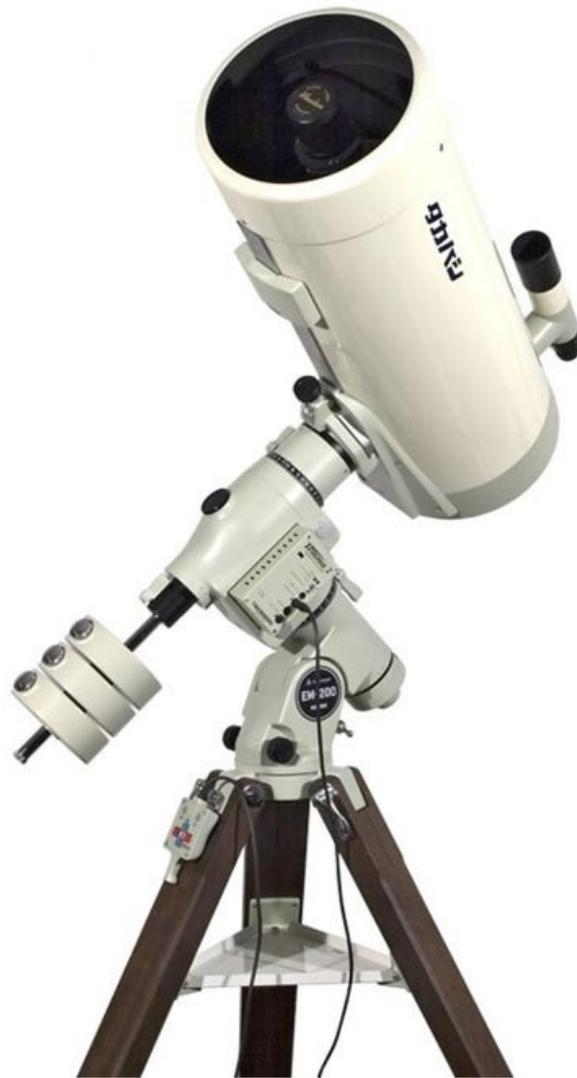
Fig. 4.4: Telescopio Takahashi Mewlon-210 con el que se realizaron los experimentos.
