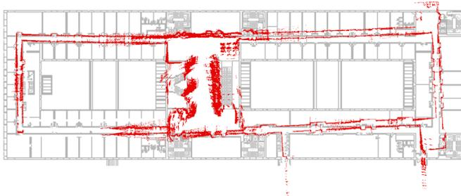
(c) Mapa generado mediante fusión por EKF de odometría e ICP utilizando covarianzas estimadas para ICP según el método propuesto.
