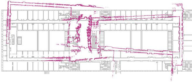
(a) Mapa generado mediante odometría basada en *encoders*.
